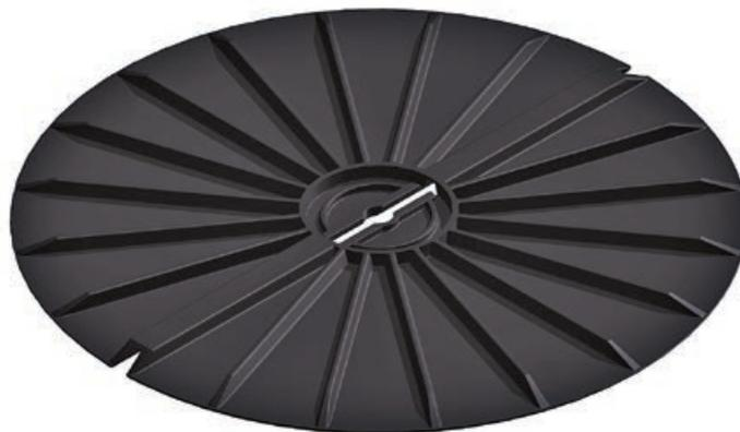
L'utilizzo principale di questo articolo è di ripartire il carico della pavimentazione su una superficie maggiore rispetto ai supporti tradizionali che hanno un diametro inferiore. Il suo utilizzo è molto semplice: è sufficiente posizionarlo sotto ai supporti per pavimenti sopraelevati.
