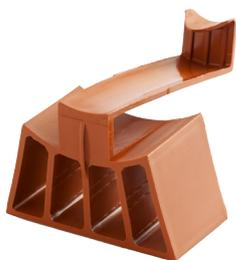
in polipropilene copolimero stabilizzato ai raggi U.V.A.: elemento di rialzo ed ancoraggio, da applicare sul retro di ogni coppo canale. La staffa a Z permette di agganciare il coppo canale successivo retrostante, consentendo così la creazione di una maglia catenaria. **Non richiede il fissaggio a mezzo meccanico sul piano di posa.**
