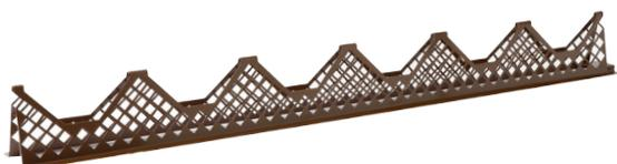
in acciaio zincato e verniciato a polveri epossidiche: elemento di partenza per la prima fila di coppi, con la funzione di parapasseri e di agganciare il manto di copertura sulla linea di gronda.
