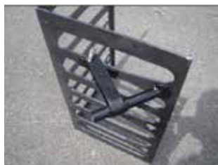
2_ APPLICAZIONE DELLA GUIDA-PUNTA ALLA MASCHERINA PER GARANTIRE LA FORATURA SECONDO L' ANGOLO PRESTABILITO
