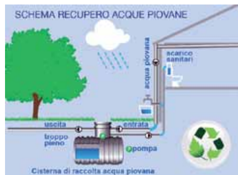
Schema di sistema di recupero di acque piovane. Fonte: www.solarea.eu
