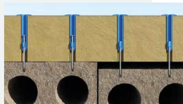
Disallineamento di elementi prefabbricati costituenti la copertura.
