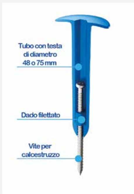
Elementi costitutivi del fissaggio ASTL.
