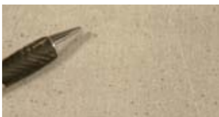
▲ Particolare di una superficie di malta dopo prova del sottopiatra non accettabile: presenza di eccessivo numero di bolle in interfaccia anche di ampie dimensioni
