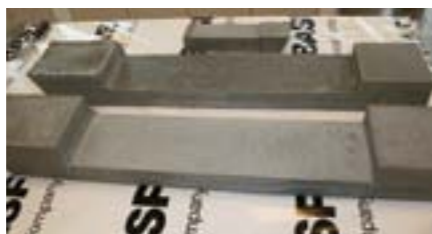
▲ Sottopiatra in plexiglass per la valutazione della quantità e della dimensione delle bolle d'aria in interfaccia
