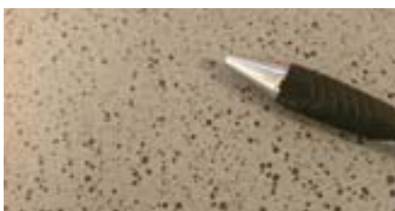
▲ Particolare di una superficie di malta dopo prova del sottopiatra non accettabile: presenza di eccessivo numero di bolle in interfaccia anche di ampie dimensioni
