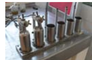
▲ Prova per la misurazione dell'espansione in fase plastica per le malte di ancoraggio (UNI 8996)
