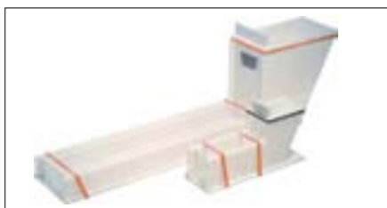
▲ Sottopiatra in plexiglass per la valutazione della quantità e della dimensione delle bolle d'aria in interfaccia
