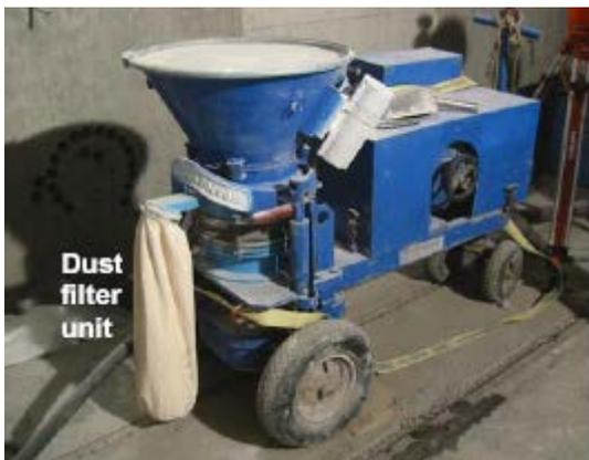
Il riempimento della tramoggia della pompa con il prodotto secco deve essere eseguito con cura evitando di creare polvere in eccesso.
