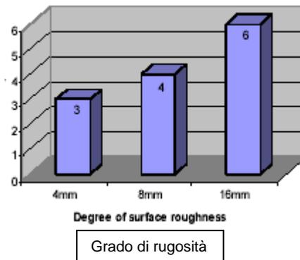
Se la rugosità della superficie del supporto richiede più di 6 kg/m<sup>2</sup> di MasterSeal 345, si può pensare di eseguire una lisciatura applicando un leggero strato di malta cementizia (con Ø max inerte di 4 mm). Il consumo del MasterSeal 345 è fortemente influenzato dal grado di rugosità della superficie del supporto.
