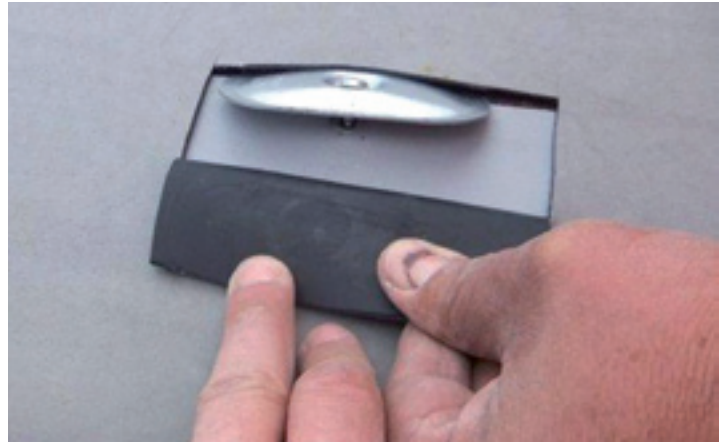
"Pull out" estrazione di una fissaggio a vite autofilettante, con placchetta ovale, dalla faccia superiore di una lamiera "sandwich" a basso spessore (0,55 mm)
