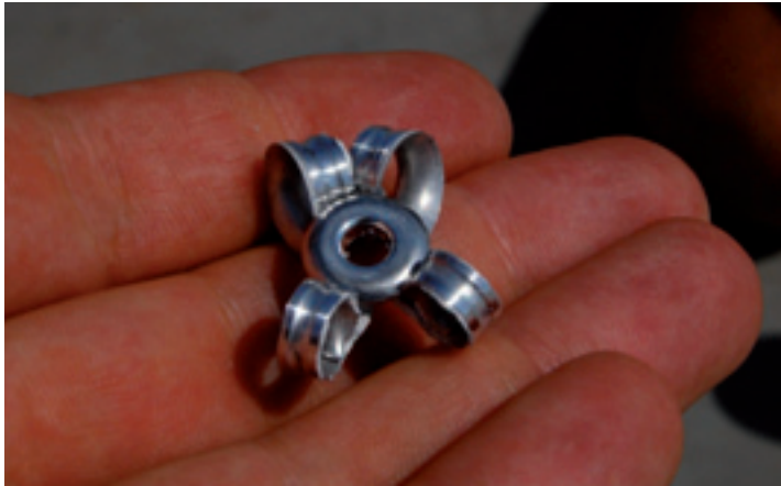
Rivetto a fiore largo, per fissaggi su lamiere, con spessore < 0,75 mm per evitare estrazione per "pull out"
