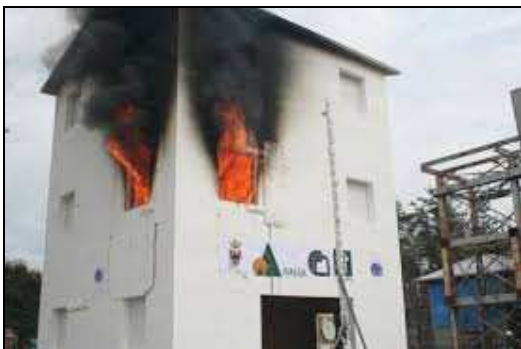
Fig. 1 - Prototipo di un edificio con struttura in legno sottoposto ad una prova di resistenza al fuoco R60. L'edificio sul cui fianco si vede il legno strutturale, è stato intonacato all'esterno mentre all'interno la struttura in legno è stata ricoperta da una lastra incombustibile di cartongesso.
