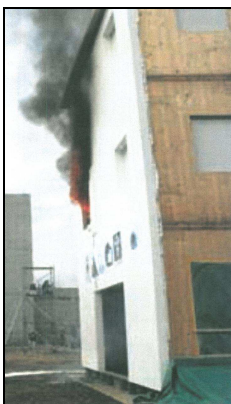
Fig. 1 - Prototipo di un edificio con struttura in legno sottoposto ad una prova di resistenza al fuoco R60. L'edificio sul cui fianco si vede il legno strutturale, è stato intonacato all'esterno mentre all'interno la struttura in legno è stata ricoperta da una lastra incombustibile di cartongesso.
