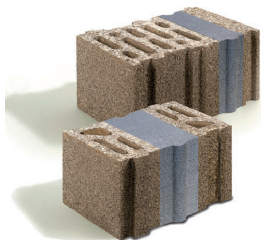
Frutto di una articolata tecnologia produttiva, il blocco alleggerito in calcestruzzo e argilla espansa vive una nuova stagione grazie all'unione virtuosa con isolanti ad alta densità come il polistirene, in questo caso interposti tra un blocco interno portante e uno esterno con funzione di protezione dell'isolante stesso. Il risultato? Un manufatto utilizzabile sia per la costruzione di murature di tamponamento di strutture intelaiate, sia di murature portanti, ordinarie o armate, idonee anche per l'edilizia antisismica (Lecasistemi).
