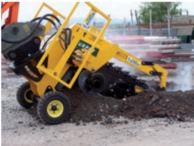
Destinata all'utilizzo su terreni morbidi e strade bianche, l'escavatrice a catena consente, come le versioni a disco, di contenere la sezione di scavo allo stretto necessario (AFT).
