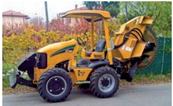
L'evoluzione della specie: da accessorio idraulico destinato al montaggio su mezzi d'opera autonomi a vera e propria macchina dedicata allo scavo di trincee. Adatta soprattutto alle imprese specializzate (Vermeer).
