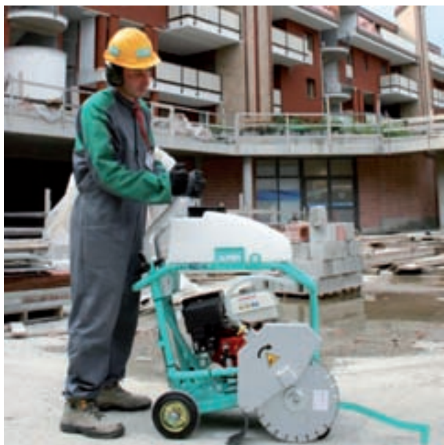
Classica, ma sempre funzionale: la taglierina rimane un indispensabile ferro del mestiere quando si tratta di realizzare piccoli scavi con metodologie tradizionali (Imer).
