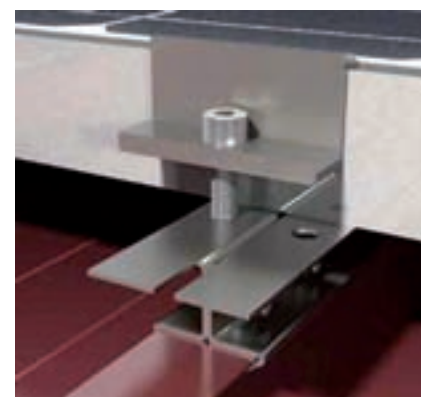
Particolare attenzione va dedicata, in caso di installazione di impianti, nell'evitare forature dei pannelli che potrebbero comprometterne la tenuta, utilizzando i numerosi sistemi di aggancio prefabbricati messi a disposizione dai produttori. Nella sequenza di immagini, due esempi di posa scorretta con relative infiltrazioni del pannello, e un ancoraggio specificamente progettato per l'utilizzo su pannelli sandwich grecati (Isolpack).
