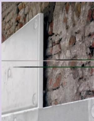
finitura perimetrale e superficiale; sono disponibili: lastre corte, 1200x600 mm, a spigolo vivo e battentato, versatili e di facile posa; lastre lunghe, 2800x600 mm, con incastro laterale maschio-femmina, per un isolamento a tutta altezza dell'intercapedine di parete; lastre con trama in rilievo per favorire l'aggrappo delle malte, ideale per l'impiego nei sistemi di protezione termica integrale all'estradosso della parete.
